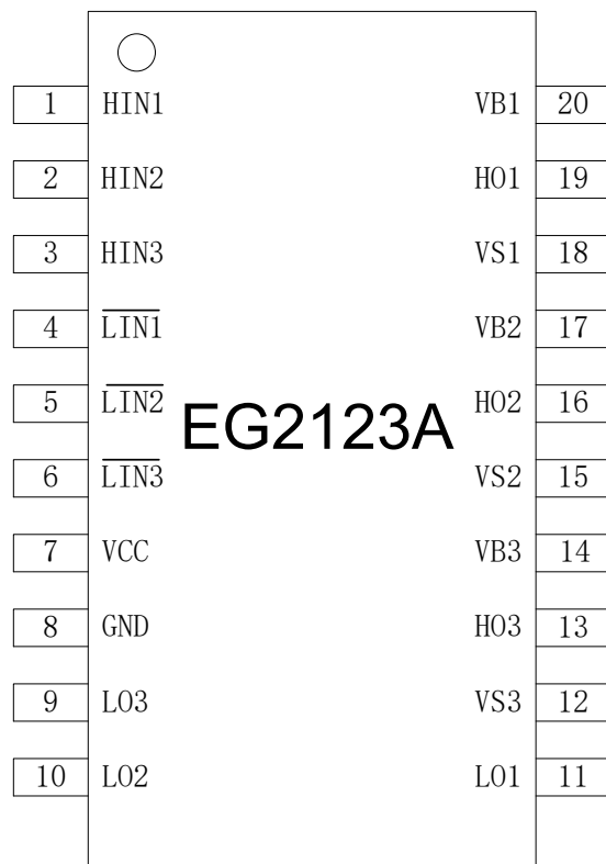
图 4-1. EG2123A 管脚定义
